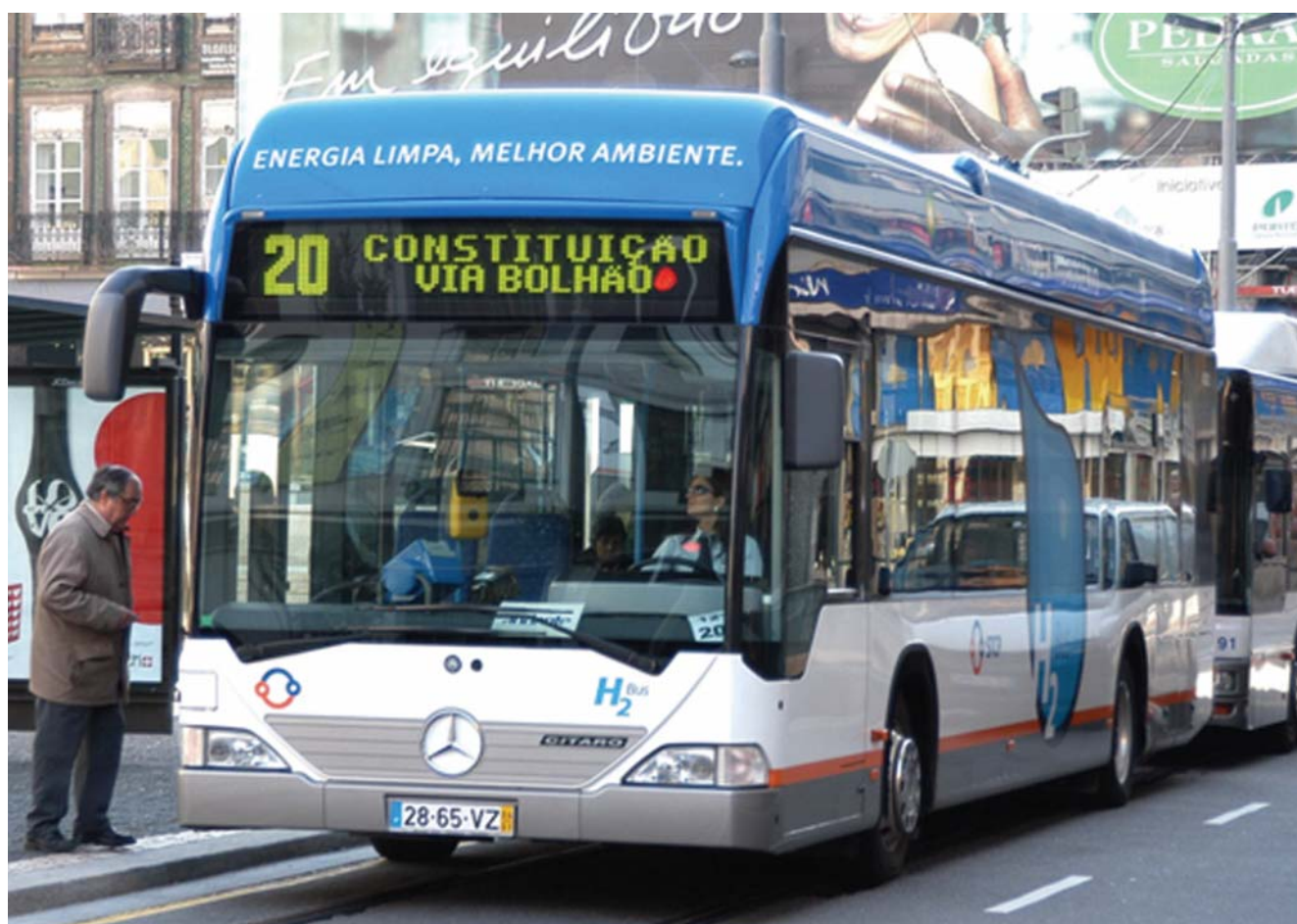
Fig. 8.4 - Autocarro com tracção eléctrica na cidade do Porto, com células de combustível alimentadas a hidrogénio puro (Fonte: www.fuel-cell-bus-club.com ).
