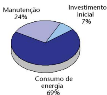
Fig. 5.17. – Diagrama de custos típico durante a vida útil de um sistema de iluminação.
